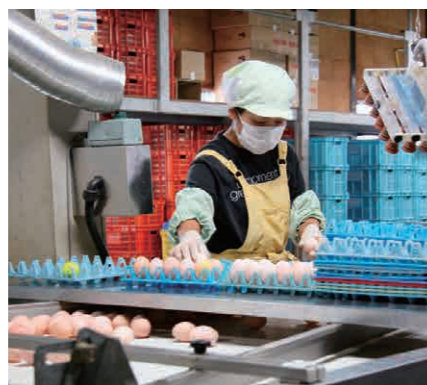
人の目で殻のヒビ、汚れを厳重に検査します
